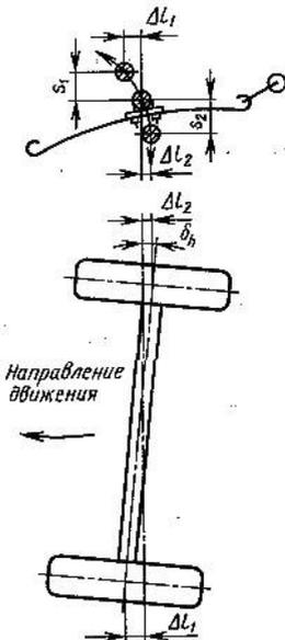
Рис. 1.20. Наклонные продольные рессоры с опущенными передними (по сравнению с задними) точками крепления к кузову осуществляют поворот задней оси в направлении недостаточной поворачиваемости. При крене кузова наружное при повороте колесо, совершая ход сжатия  $s_1$ , перемещается вперед на  $\Delta l_1$ , а внутреннее при ходе отбоя  $s_2$  перемещается назад на  $\Delta l_2$ . В результате ось поворачивается на угол  $\delta_h$ .
